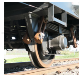
Bereich um die Achslager und Radsätze mehrteilig ausgeführt
