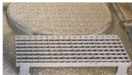
Laufgitter am Dach mit fein durchbrochen dargestelltem Ätzteil umgesetzt
