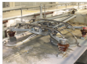
Stromabnehmer DSA 200 mit unsichtbarer Befestigung
