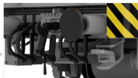
Pufferbohle mit Puffergriff und weiteren Steckteilen
