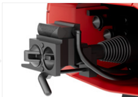
Mehrteilig nachgebildete Scharfenbergkupplung
