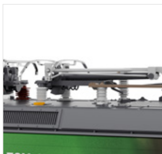
Stromabnehmer ohne sichtbare Befestigung
