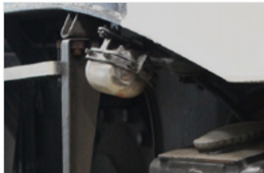
BR 139 mit digital schaltbaren Anfahrampen im Fahrwerksbereich
