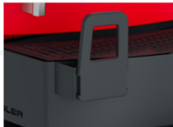
Freistehende Rangiererhandgriffe an der Pufferbohle
