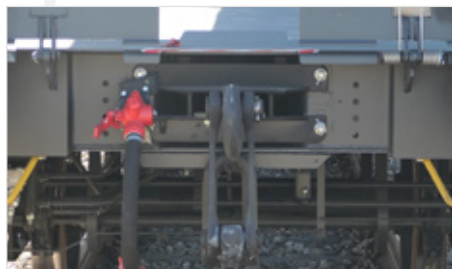
Pufferbohle komplett zurüstbar mit Bremsschlauch und Kupplungsnachbildung
