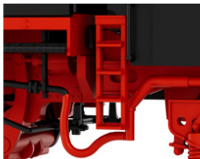
Verbindung zwischen Lok und Tender umgesetzt
